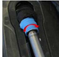
Stecken Sie den Stecker wieder hinein. Kontrollieren Sie, dass er richtig bis zum Anschlag eingerastet ist.
