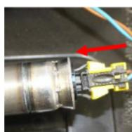
Plaats het opblaassysteem in zijn behuizing.
