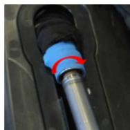
Steek de stekker weer terug in het opblaassysteem. Controleer of het opblaassysteem tot de aanslag correct vergrendeld is.
