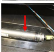
Stellen Sie sicher, dass der Inflator korrekt positioniert und vollständig in seinem Gehäuse eingerastet ist.
