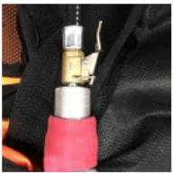
Con questo adattatore e usando una pompa o un compressore, gonfiare il gilet fino a 0,3 bar (5 psi) e verificare che non si sgonfi in meno di 5 secondi. (Per questa operazione può essere adatto ogni sistema pneumatico di gonfiaggio, come ad esempio quelli disponibili nelle stazioni di servizio.)
